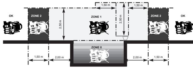
Installer pumpen på et luftet, tørt rom. Forutse fritt rom på 0,5 m rundt pumpen. Motoren krever at luften sirkulerer fritt rundt pumpen slik at den luftes naturlig. Sjekk regelmessig at verken gjenstander, blader eller noe annet tilstopper motorens kjølesystem.
