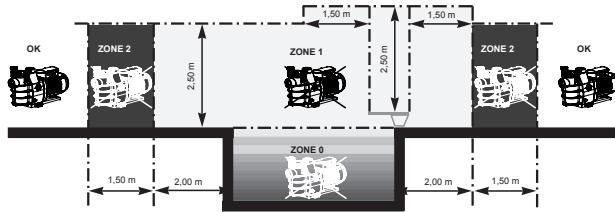
Instalar a bomba num local ventilado e seco; o motor precisa que o ar circule livremente à volta da bomba para permitir a sua ventilação natural. Considerar uma folga mínima de 0,5 m à volta da bomba. Verificar regularmente que objectos, folhas ou quaisquer outros elementos não obstruem a refrigeração do motor.
