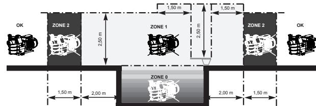
Asenna pumpu tuuletettuun ja kuivaan paikkaan, moottori tarvitsee vapaasti kiertävää ilmaa sen ympärille luonnollisen tuuletuksen mahdollistamiseksi. Varaa pumpun ympärille vähintään 0,5 m tyhjää tilaa. Tarkasta säännöllisesti, etteivät esineet, lehdet tai mikään muu tilaa vievää tuki moottorin jäähdytystä.
