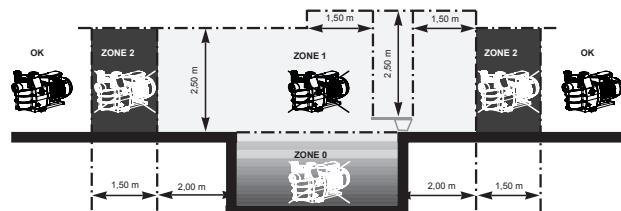
Installera pumpen i ett torrt utrymme med god luftväxling. Tillhandahålla ett minsta avstånd på 0,5 m runt pumpen. Motorns naturliga kylling kräver att luften runt den kan cirkulera fritt. Kontrollera regelbundet att inga föremål, löv eller annat blockerar motorkyllingen.
