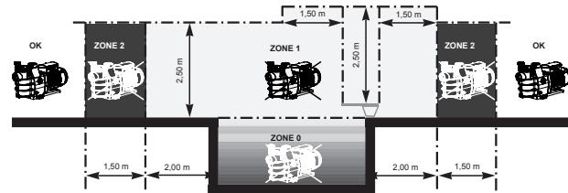
Installer pumpen i et tørt lokale med god ventilation, da motoren kræver, at luften kan cirkulere frit omkring den og skabe naturlig ventilation. Der skal være en friplads på 0,5 m omkring pumpen. Se jævnligt efter, at genstande, blade eller andet ikke kan komme til at hindre afkøling af motoren.
